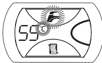
Рис. 5 Индикация настройки температуры ГВС
