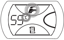
Рис. 5 Индикация настройки температуры ГВС
