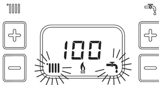
рис. 13- Режим TEST (мощность системы отопления = 100%)
