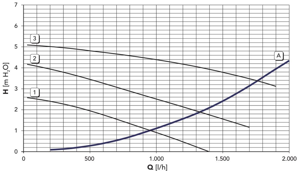
A = Потери нагрузки в котле - 1, 2 и 3 = Скорость циркуляционного насоса
