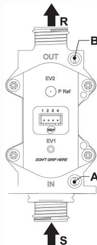
При первом пуске необходимо проверить настройку газового клапана - максимальное и минимальное давление газа на форсунках горелки (режим «Тест»)
